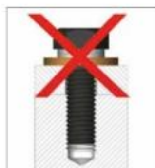
Sin función de seguridad en combinación con arandelas que giran libremente
