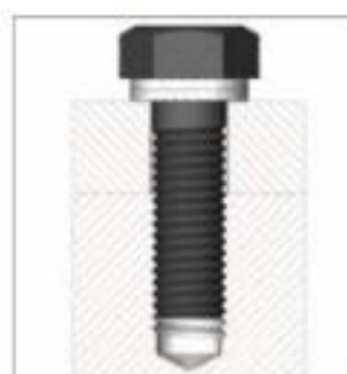
Tornillo hexagonal asegurado en un agujero ciego
