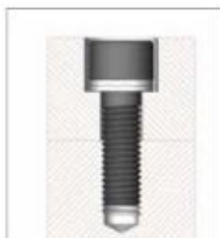
Tornillo cilíndrico asegurado en un agujero ciego
