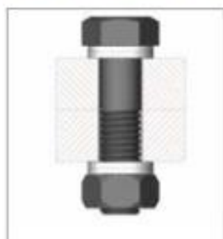
Tornillo hexagonal pasante asegurado a ambos lados
