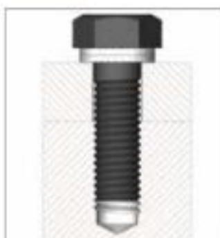
Tornillo hexagonal asegurado en un agujero ciego
