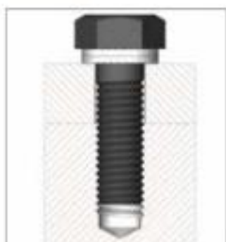
Tornillo hexagonal asegurado en un agujero ciego
