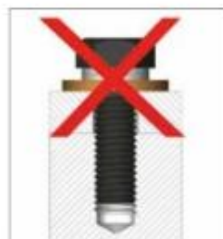
Sin función de seguridad en combinación con arandelas que giran libremente
